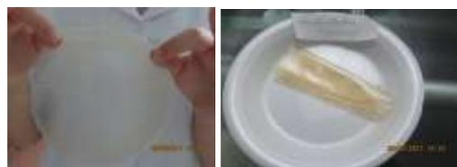
En ambos prototipos las películas plásticas obtenidas presentan propiedades de flexibilidad, mediana resistencia y un buen grado de transparencia; con un resultado más favorable para el prototipo 2; lo cual es viable elaborar plásticos a base de biopolímeros. Se debe seguir una línea de mejoramiento para lograr una mayor resistencia y un producto totalmente aséptico sin ningún tipo de olor o sabor.
